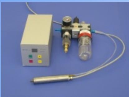
Комплектная система HF25 с регулятором оборотов и блоком воздушно-масляного питания
