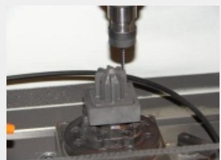
Фрезерование графитовых электродов на HF80
