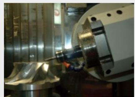
Пятиосевое фрезерование турбинных лопаток на HF120
