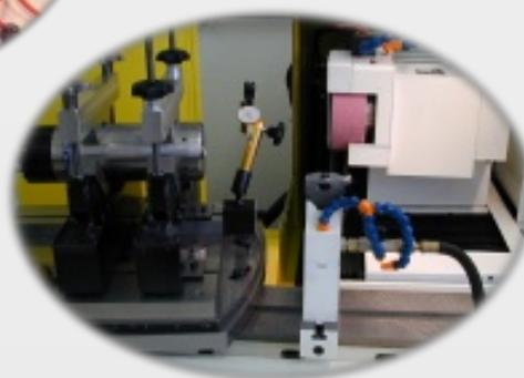
Шлифование передней части и конуса шпинделя
