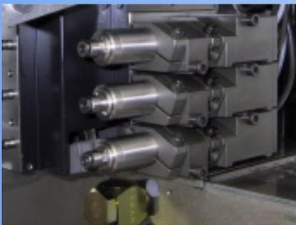
Шпиндели HF25 на токарном станке "швейцарского типа"
