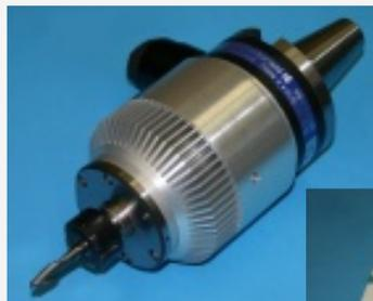
НФК 95: 40 000 об/мин, 1 кВт, 0.2 Нм, максимальный диаметр инструмента - 6 мм
