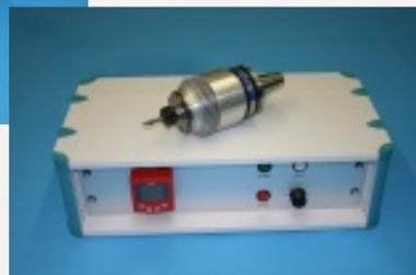
НФК 90.1 для США, Азии и Восточной Европы с 220 V AC-мотором: 42 000 об/мин, 1.9 кВт, 0.4 Нм, максимальный диаметр инструмента - 10 мм. На рисунке показана комплектная система НФК 90.1 с преобразователем частоты и блоком охлаждения
