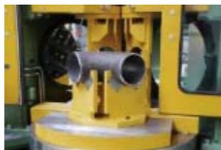
Обработка концов колен трубопроводов на станке с числовым программным управлением
