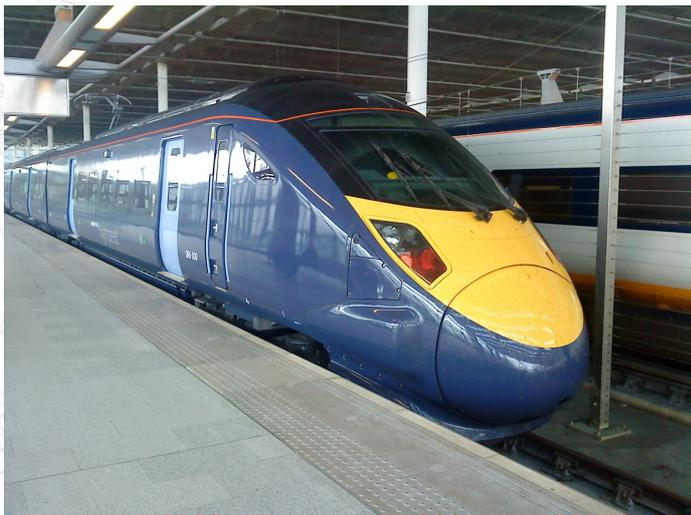
Корпус мощного высокопрочного поезда метро **Hitachi** железнодорожного транспорта Великобритании Класс 395 изготавливается из продольных алюминиевых экструзий с использованием **HSC** и **FSW**
